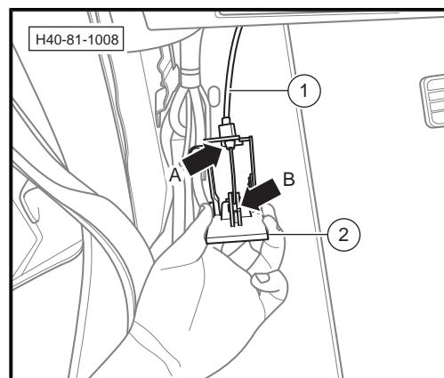
11. 脱开发动机盖锁拉线橡胶堵-1-与车身的连接。
