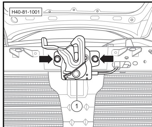
3. 从-箭头A-、-箭头B-位置脱开发动机盖锁体总成-1-与拉线的连接。
