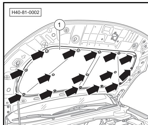
5. 旋出发动机盖固定螺栓-箭头-, 取下发动机盖钣金焊接总成-1-。
