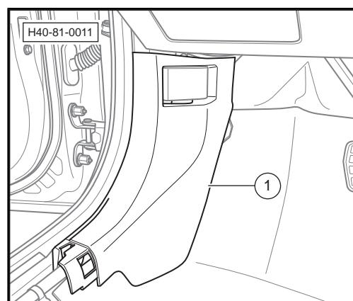
9. 沿-箭头-方向脱开拉线扣手-1-与车身的连接。
