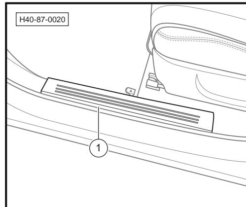
8. 拆下A柱下饰板总成-1-。
