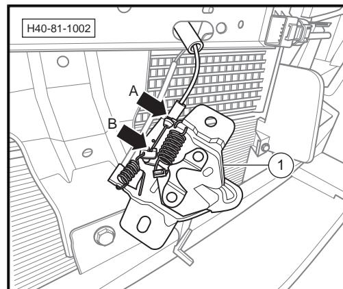
4. 脱开发动机盖锁拉线总成-1-的固定卡扣-箭头-与车身的连接。
