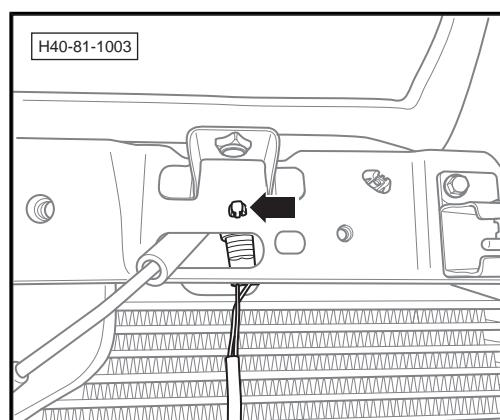
5. 断开线束连接插头-箭头-, 取下发动机盖锁体总成-1-。
